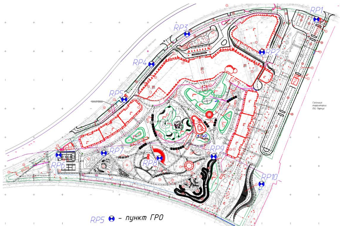
Рис. 8 Предварительная схема размещения пунктов ГРО
