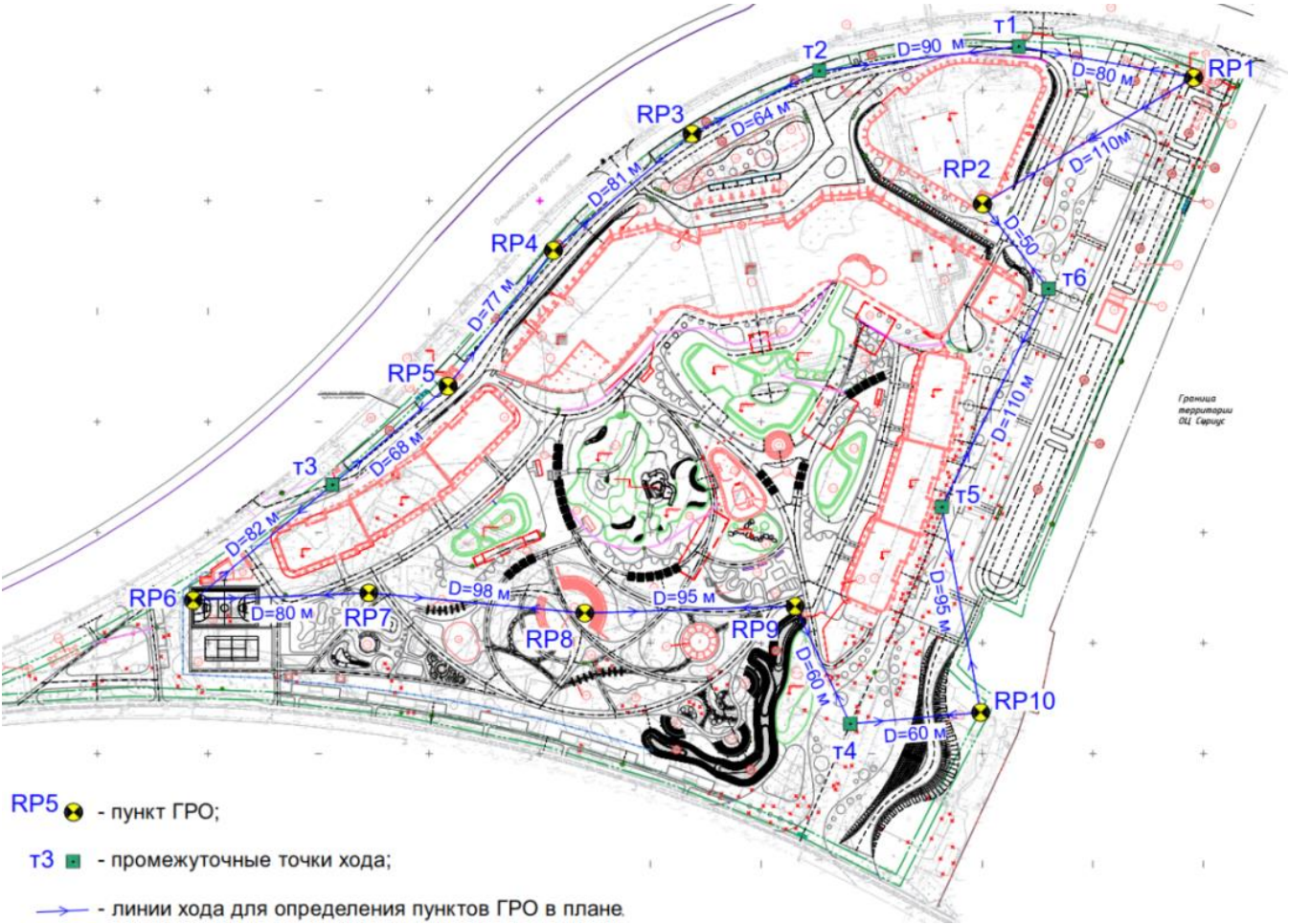
Рис. 11 Предполагаемая схема хода для определения планового положения пунктов ГРО
