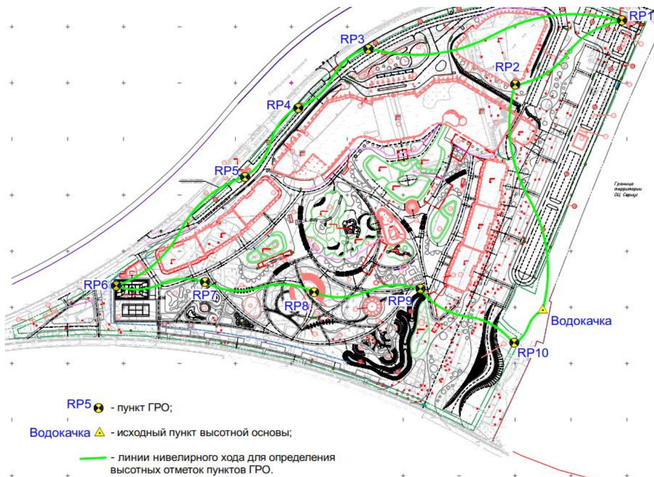
Рис. 13 Предполагаемая схема нивелирного хода для определения высотного положения пунктов ГРО
