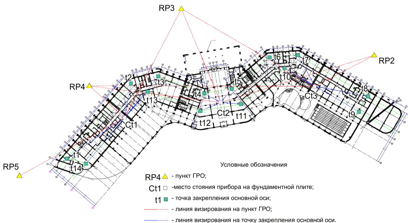
Рис. 15 Схема внутренней разбивочной сети здания гостиницы
